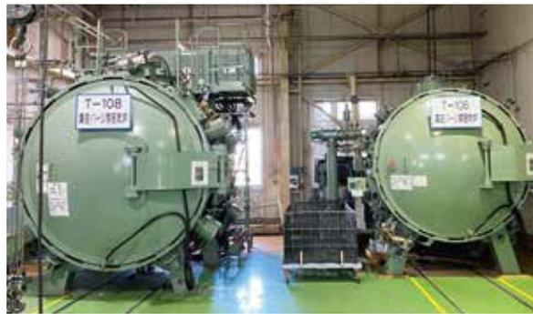
バッチ式真空炉、雰囲気炉
