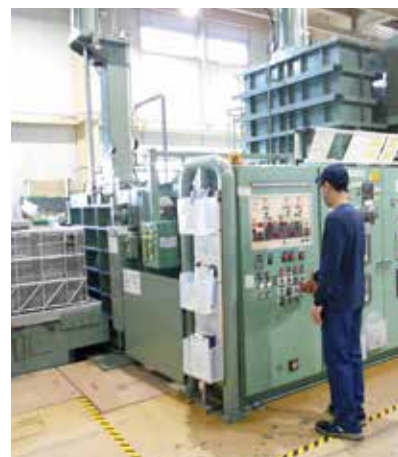
▲大型真空熱処理炉 (1240W×2050L×900H)
